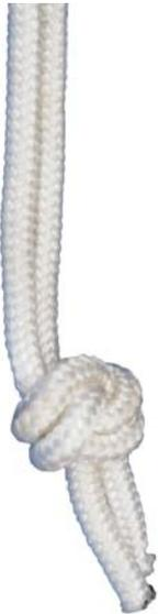
Cabo fabricado con fibras de Poliamida de alta tenacidad. Una de las características de la Poliamida es su capacidad de encogimiento, con lo que se consigue incrementar en gran medida la durabilidad de los nudos. Por esa razón, está especialmente indicada para labores en las que son necesarios los nudos.
