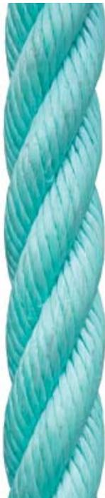
Cordage mixte semi-métallique, spécialement conçu pour les racleurs. Ce cordage a une couverture d'Itsasplus qui lui confère une excellente résistance à l'abrasion, et un acier galvanisé intérieur qui lui apporte la ténacité et la force nécessaires pour faire son travail.
