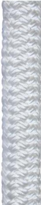
Corde tressée fabriquée à base des fibres de Polyamide d'haute ténacité. Sa construction de construction neutre empêche la rotation quand il a charge de travail. À cause de son manque de flottabilité, c'est un cordage fréquemment utilisé dans des installations d'amarrage marins. Également, sa grande ténacité et flexibilité font ce cordage idéal pour l'amarrage des bateaux.
