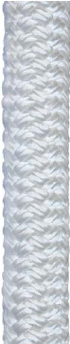
Cabo fabricado con fibras de Poliéster de alta tenacidad. Su construcción de torsión neutra evita el giro en carga de trabajo. La gran característica de este material es su gran estabilidad en mojado, por su baja elongación y poco encogimiento. Además, es un material que no se vuelve rígido al utilizarse en mojado. Es un cabo frecuentemente utilizado en amarre de instalaciones marinas.
