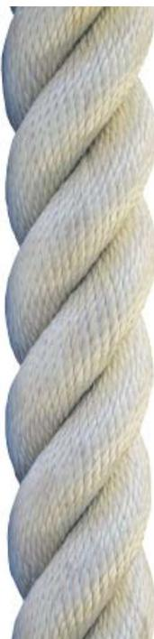
Corde tressée fabriquée à base des fibres de Polyester d'haute ténacité. La grande caractéristique de ce matériau est sa grande stabilité au contact de l'eau, pour son faible allongement et peu rétrécissement. Également, c'est un matériel que ne devient pas rigide quand il est utilisé en mouillée. À cause de son manque de flottabilité, c'est un cordage fréquemment utilisé dans des installations d'amarrage marins.
