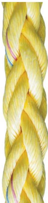
Corde tressé de 8 torons (4x2). Sa couverture d'Itsasplus lui confère une grande résistance à l'abrasion. Également, sa bonne flexibilité, maniabilité et flottabilité, en font une corde idéale pour mouillage.
