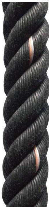
Cabo mixto de 3 o 4 cordones específicamente diseñado para la pesca de cerco. Su especial construcción de torsión dura, la hace idónea para el cierre de la red de cerco al paso por las anillas.
