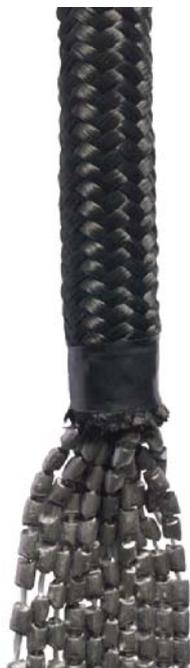
Cordage tressé fabriqué avec fibres de Polyester de haute ténacité et composé de plusieurs rosaires de plomb, qu'apportent une haute densité et faible diamètre. Grâce à cette construction, ce cordage a une grande facilité de submersion, et étant donnée sa double couverture tressée de polyester de haute ténacité, il a une excellent résistance à l'abrasion.
