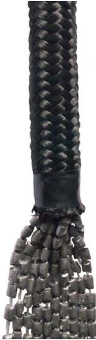
Cabo trenzado fabricado con poliéster de alta tenacidad y compuesto de una serie de rosarios de plomo, que aportan una alta densidad y bajo diámetro. Gracias a esta construcción, este cabo tiene un gran poder de hundimiento, y debido a su doble cubierta trenzada de poliéster de alta tenacidad, posee una excelente resistencia a la abrasión.
